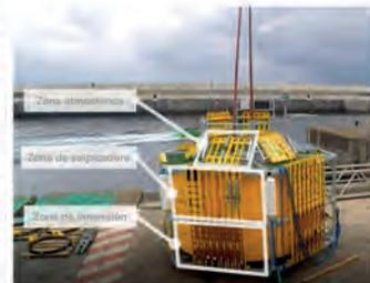
HarshLab1.0 permite ensayar nuevos materiales y soluciones contra la corrosión, el envejecimiento y el fouling en entorno offshore real, en condiciones controladas
